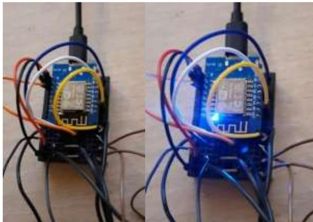
Figure 10: Wemos D1 mini blinking
